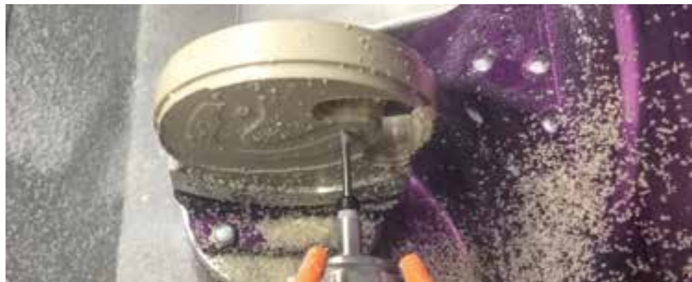
Abb. 6 Ausfräsen des Sekundärgerüsts aus ungefülltem PEEK (YuDent, Yunyi Medical)
