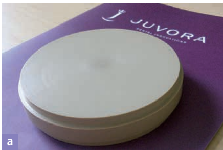
Abb. 13a und b Die Umsetzung der virtuellen Konstruktion erfolgte CAD/CAM-gestützt (PEEK, Material-Blank: Juvora Dental Disc).
